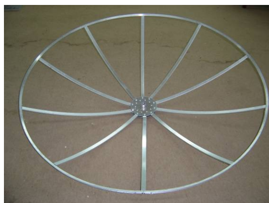
Estrutura da Antena montada
