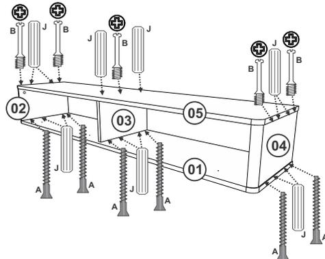
Fixar as peças 02, 03 e 04 na peça 01 com Cavilha 6x20 e Parafuso 5x50.
