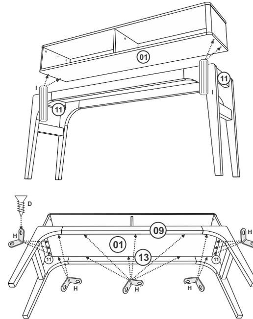
Fixar a peça 01 nas peças 11 com Cavilha 8x30. Fixar as peças 09, 13 e 11 na peça 01 com Cantoneira Metálica e Parafuso 3,5x12.
