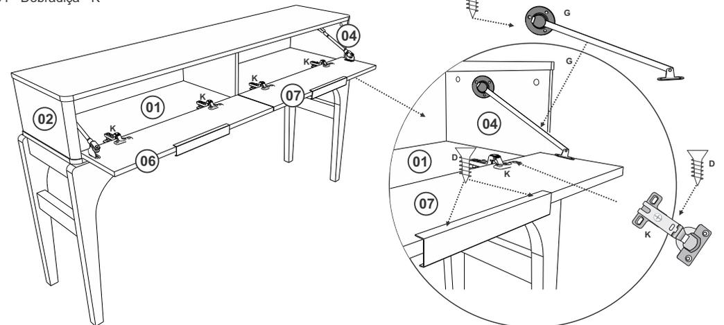
Fixar os Articuladores nas peças 02 e 04 com Parafuso 3,5x14. Fixar as dobradiças com Parafuso 3,5x12 nas peças 01, 06 e 07.
