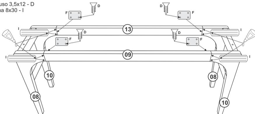
Fixar as peças 09 e 13 nas peças 08 e 10 com Cavilha 8x30 e Chapinha de Ferro com Parafuso 3,5x12 conforme ilustração a cima.
