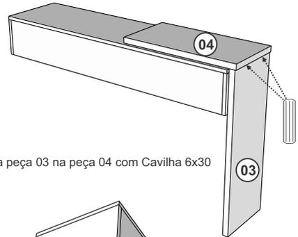
Fixar a peça 03 na peça 04 com Cavilha 6x30
