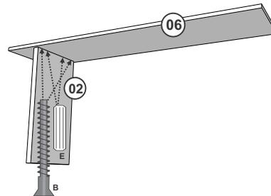
Fixar a peça 02 na peça 06 com Cavilha 6x30 e Parafuso 5x50
