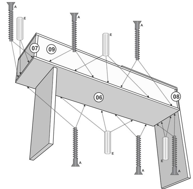
Fixar a peça 06 nas peças 07, 08, 09 e 10 com Parafuso 5x40 e Cavilha 6x30.
