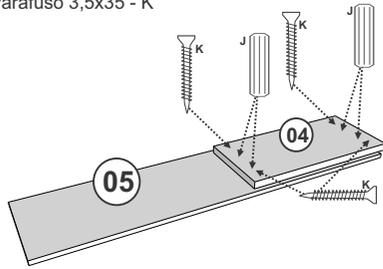
Fixar a peça 04 na peça 05 com Cavilha 6x20 e Parafuso 3,5x35.
