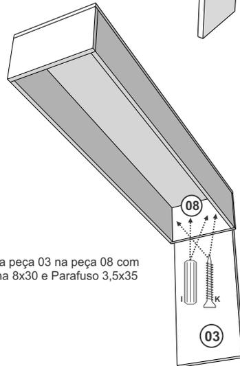
Fixar a peça 03 na peça 08 com Cavilha 8x30 e Parafuso 3,5x35
