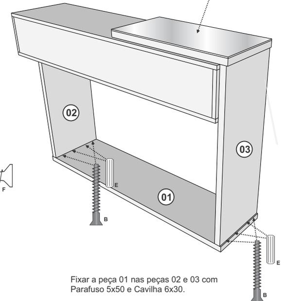
Fixar a peça 01 nas peças 02 e 03 com Parafuso 5x50 e Cavilha 6x30.
