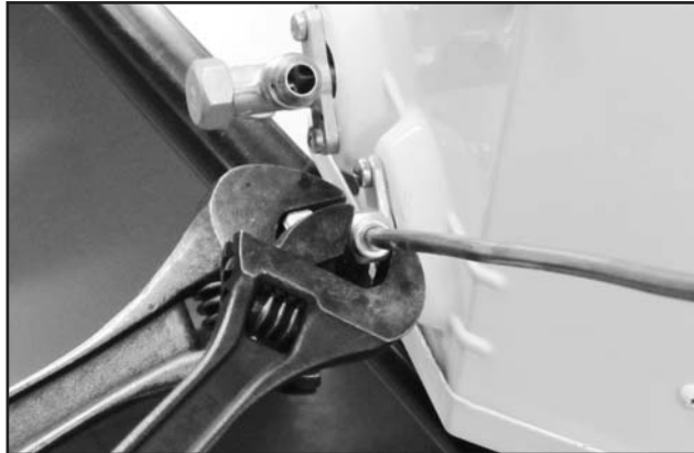
FIG. 31 - FIXAÇÃO DA PORCA
