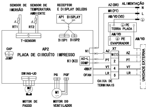
**Esquema Elétrico Interno (Quente/Frio):**
