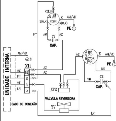
**Esquema Elétrico Externo Quente/Frio):**
