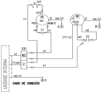
**Esquema Elétrico Externo (Frio):**
