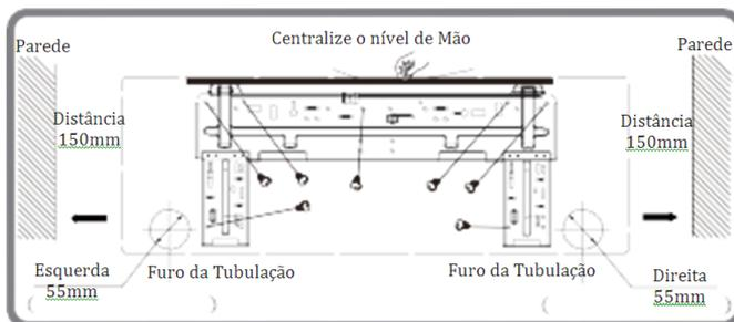
2. Abra um furo de tubulação com o diâmetro de 55mm ou 70mm na posição do tubo de saída selecionada. Para uma boa drenagem, incline o furo da tubulação na parede ligeiramente para baixo, para o lado externo, com o ângulo de 5-10°.
