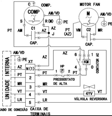
**Esquema Elétrico Externo**
