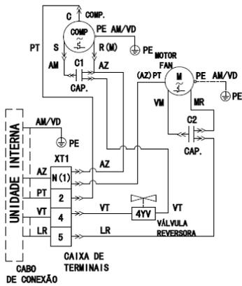
**Esquema Elétrico Externo (Quente/Frio):**
