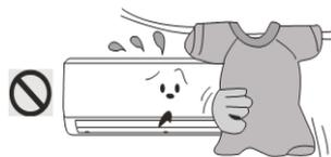
Não bloqueie as entradas e saídas de ar das unidades internas e externa, isto pode causar mau funcionamento do aparelho.
