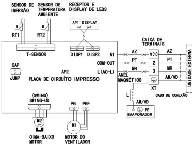
**Esquema Elétrico Interno (Frio, Quente/Frio):**
