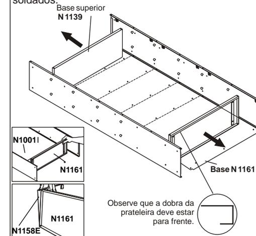
**PASSO 4:** Encaixe as laterais e parafuse o conjunto.
