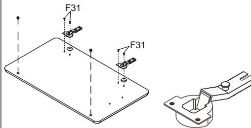
Obs: dobradiça fixada com parafusos
