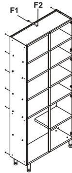
É obrigatório a fixação do móvel na parede.
