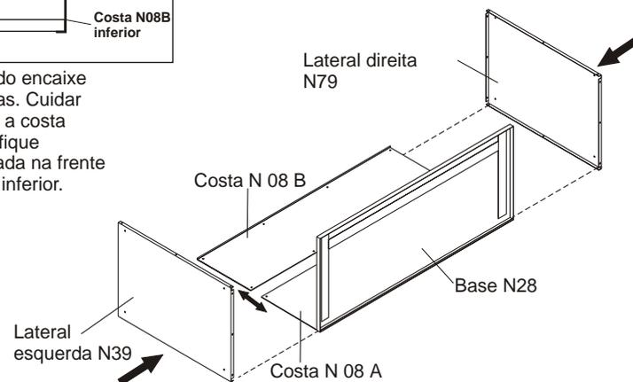
Encaixe a lateral na costa e após coloque a base parafusando o canto superior na lateral. Encaixe a outra lateral e parafuse.
