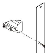
B - Fixar o calço com o auxílio de dois parafusos autoatarraxantes zincado branco F40 na lateral do perfil.
