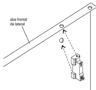
**B** - Fixar o calço com o auxílio de dois parafusos autoatarraxantes zincado branco F40. Repetir o mesmo procedimento com o outro calço.
