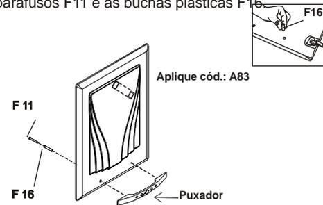
OBS: Limpe bem a superfície da porta, retire o plástico protetor do aplique adesivo e coloque-o no local indicado, pressionando bem sobre o aplique.
