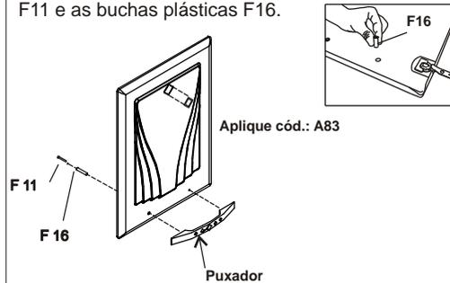
OBS: Limpe bem a superfície da porta, retire o plástico protetor do aplicador adesivo e coloque-o no local indicado, pressionando bem sobre o aplicador.
