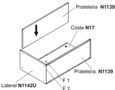
Encaixe a lateral N1142U por baixo da costa N17 e após coloque as prateleiras N1139 parafusando o canto superior na lateral.
