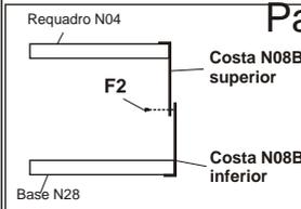
Detalhe do encaixe das costas. Cuidar para que a costa superior fique posicionada na frente da costa inferior.
