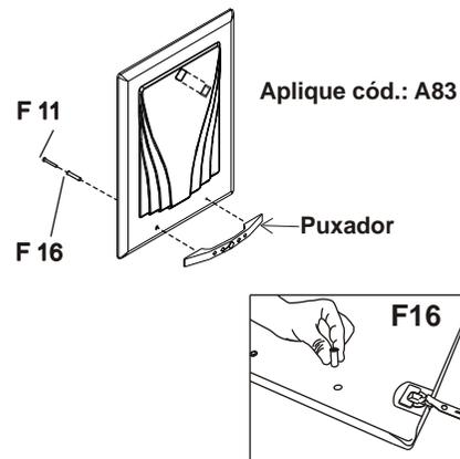
OBS: Limpe bem a superfície da porta, retire o plástico protetor do aplicador adesivo e coloque-o no local indicado, pressionando bem sobre o aplicador.
