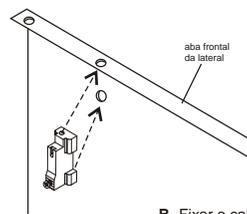
B - Fixar o calço com o auxílio de dois parafusos autoatarraxantes zincado branco F40. Repetir o mesmo procedimento na outra lateral. OBS: é necessário dois calços para cada lateral.
