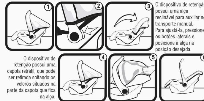
O dispositivo de retenção possui uma alça reclinável para auxiliar no transporte manual. Para ajustá-la, pressione os botões laterais e posicione a alça na posição desejada.
