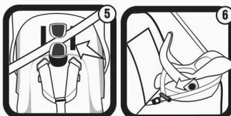
Em seguida abrace o encosto do dispositivo de retenção com o cadarço diagonal do cinto de segurança posicionando-o por baixo do encaixe da alça (fig.4 e 5).
