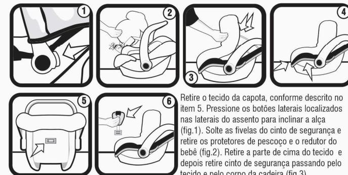
Retire o tecido da capota, conforme descrito no item 5. Pressione os botões laterais localizados nas laterais do assento para inclinar a alça (fig.1). Solte as fivelas do cinto de segurança e retire os protetores de pescoço e o redutor do bebê (fig.2). Retire a parte de cima do tecido e depois retire cinto de segurança passando pelo tecido e pelo corpo da cadeira (fig.3).
