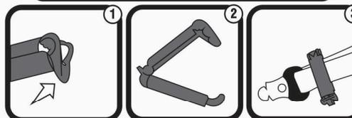
**IMPORTANTE:** Quando utilizar cinto de segurança retrátil, prenda seus cadarços com a presilha de travamento, junto ao fecho. Solte a trava da presilha (fig.1) abrindo-a (fig.2) e prenda os cadarços do cinto de segurança do automóvel, travando a presilha (fig.3).
