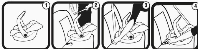
Para instalar o dispositivo de retenção no automóvel, remova a capota, conforme descrito no item 5. Posicione o dispositivo de retenção sobre o banco traseiro (fig.2). Passe o cinto de segurança primeiro pela frente do assento do dispositivo de retenção; passe o cadarço abdominal do cinto de segurança do veículo, nas aberturas laterais (fig.3).
