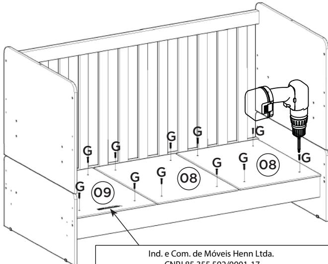
Utilizar a parafusadeira com o torque em 15 para fixar a grade e para fixar o lastro.
