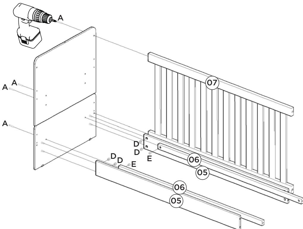
Utilizar a parafusadeira com o torque em 15 para fixar a grade e para fixar o lastro.
