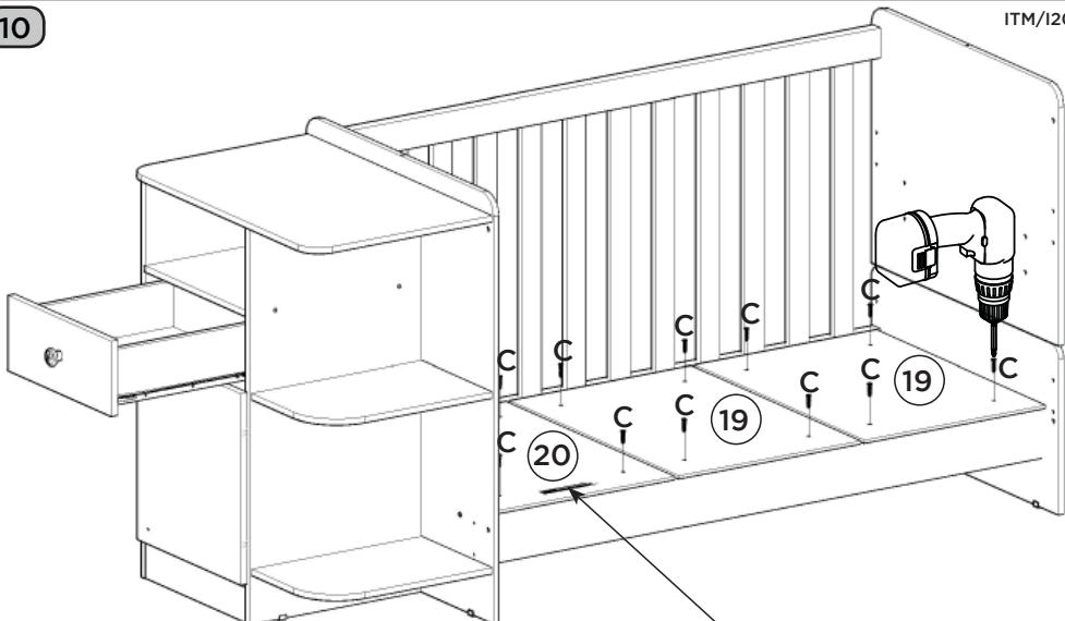
**Utilizar a parafusadeira com o torque em 15 para fixar a grade e para fixar o lastro.**
