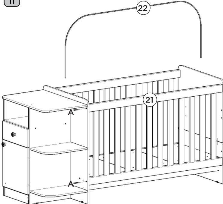
Utilizar a parafusadeira com o torque em 15 para fixar a grade e para fixar o lastro.
