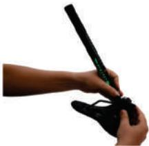
Para montar o selim da bicicleta, encaixe ele no canote e em seguida insira os parafusos. Após inserir os parafusos, aperte com uma chave allen 6mm.
