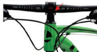
Antes de fixar os parafusos certifique-se de que o canote do guidão esteja alinhado, conforme as marcas delimitadoras trave os parafusos utilizando uma chave Allen 4mm aplicando um torque de 8N.
