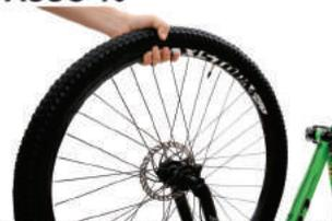
Em seguida encaixe a roda dianteira no garfo da bicicleta alinhando o disco entre as pastilhas de freio.
