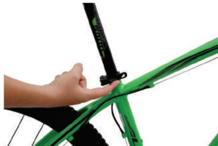
Para ajustar o selim, solte a abraçadeira, ajuste a altura respeitando a marcação permitida e feche novamente.
