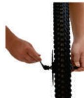
Instale a blocagem da roda dianteira.
