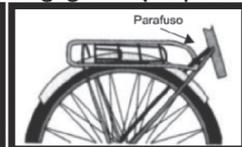
**Paralama:** Utilize os parafusos localizados no kit de acessórios que acompanham dentro da caixa. Encaixe o suporte e aperte a arruela e porca, com uma chave de fenda. Para montar as hastes do paralama, ao garfo, utilize os parafusos Philips, fixando-os com a chave fixa 10mm. (figura A).
