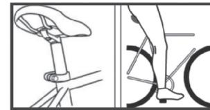
Introduza o canote do selim no quadro regulando conforme a altura do ciclista, de acordo com a figura ao lado:
