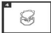
Em seguida instale a Segunda ponta do pneu no aro.
