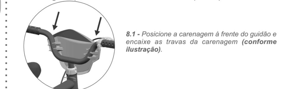
8.1 - Posicione a carenagem à frente do guidão e encaixe as travas da carenagem (conforme ilustração).
