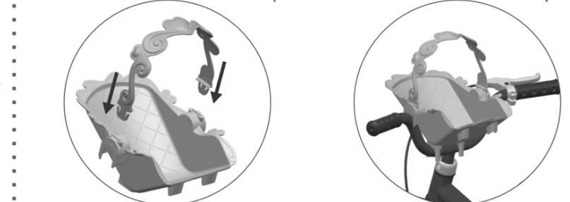
9.1 - Posicione a alça da cadeirinha, mantendo a mesma posição de encaixe conforme a ilustração. Pressione no alojamento localizado nas laterais até o seu total encaixe.
