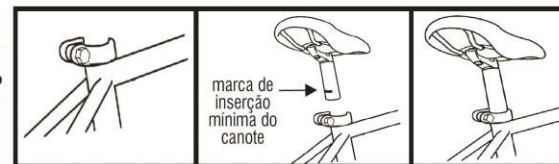
a) Solte o parafuso da abraçadeira ou abra a blocagem; b) Insira o canote de selim no tubo da bicicleta; c) Feche a blocagem e tente girar o selim;
