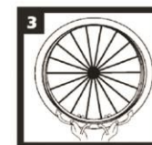
3 Coloque a câmara de ar com uma pequena quantidade de inflação (cerca de 3 PSI) para evitar que ela fique enrugada ou dobrada. Inicie pela região da válvula.
