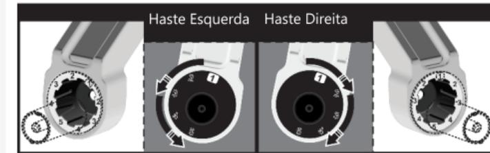
Retirar as porcas e arruelas das hastes laterais utilizando a chave 10mm. A haste direita é limitada nas posições de 1 até 5 com sentido de giro para a direita, e a haste esquerda é limitada também nas posições de 1 até 5 porém com sentido de giro para a esquerda. As posições devem sempre ser iguais (ex: 1 com 1, 2 com 2, 3 com 3 e etc). Assim que ajustado, reapertar as porcas.
