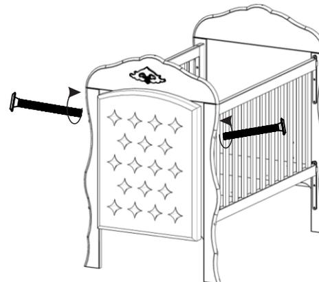
Com a parte inferior afixada, repita o procedimento do passo 1, soltando os parafusos da parte superior.
