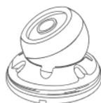
5. Pressione o anel menor juntamente com a cúpula da câmera forçando para baixo.
