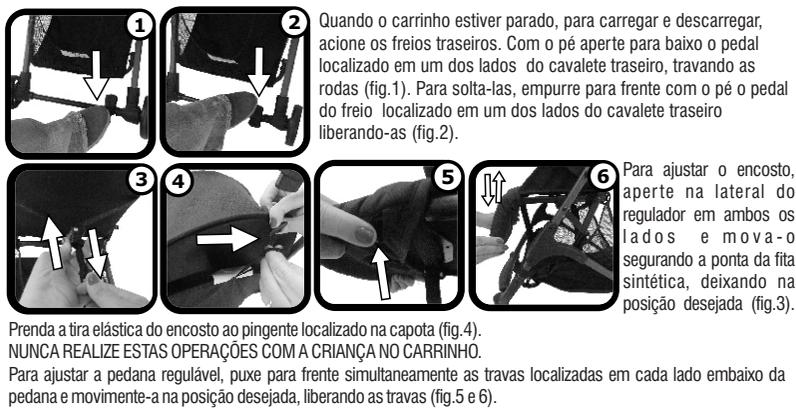
Quando o carrinho estiver parado, para carregar e descarregar, acione os freios traseiros. Com o pé aperte para baixo o pedal localizado em um dos lados do cavalete traseiro, travando as rodas (fig.1). Para solta-las, empurre para frente com o pé o pedal do freio localizado em um dos lados do cavalete traseiro liberando-as (fig.2).
