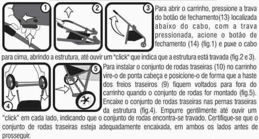
1 Para abrir o carrinho, pressione a trava do botão de fechamento (13) localizada abaixo do cabo, com a trava pressionada, acione o botão de fechamento (14) (fig.1) e puxe o cabo para cima, abrindo a estrutura, até ouvir um "click" que indica que a estrutura está travada (fig.2 e 3).
