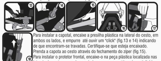
13 Para instalar a capotal, encaixe a presilha plástica na lateral do cesto, em ambos os lados, e empurre até ouvir um "click" (fig.13 e 14) indicando de que encontram-se travadas. Certifique-se que esteja encaixado. Prenda a capota ao cesto através do fechamento do zíper (fig.15).
