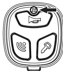
Com auxílio de uma chave Phillips, retire o parafuso e a tampa do módulo de som.
