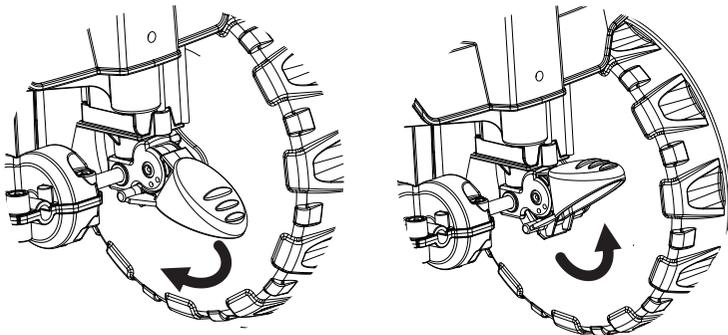
Pressione o pedal do freio posicionando-o para baixo para frear o veículo. Para colocar o veículo em movimento, faça a operação inversa, posicionando o pedal do freio para cima.
