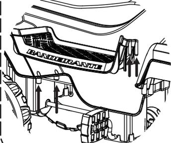
Pressione as duas extremidades do apoio de pé para cima, desencaixando os pinos do orifício de encaixe no corpo. **(Para inserir novamente o apoio faça a operação inversa).**
