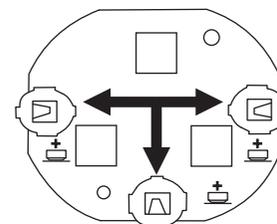
Retire o módulo de som do guidão e retire as baterias do módulo de som.
