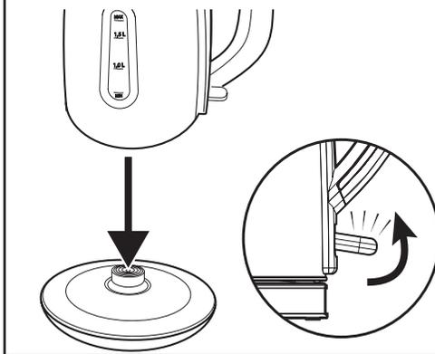
3. Quando a água ferver, o aparelho desligará automaticamente, e a lâmpada-piloto se apagará. **ATENÇÃO:** Nunca abra a tampa do aparelho durante o funcionamento. O processo de fervura pode ser interrompido a qualquer momento, basta mudar a chave de Liga/Desliga do aparelho.
