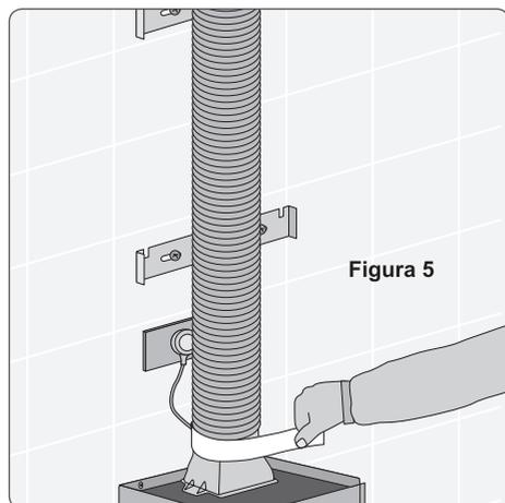
7 Coloque o plugue do cabo de alimentação na tomada. Para que o cabo de alimentação não fique aparente, é recomendável que a tomada onde ele será conectado esteja na área coberta pela chaminé.
