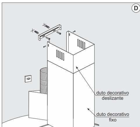
Conectar o produto à rede elétrica. A próxima etapa é passar o duto deslizante por dentro do duto fixo e parafusá-lo no suporte conforme ilustração E (detalhe x).
