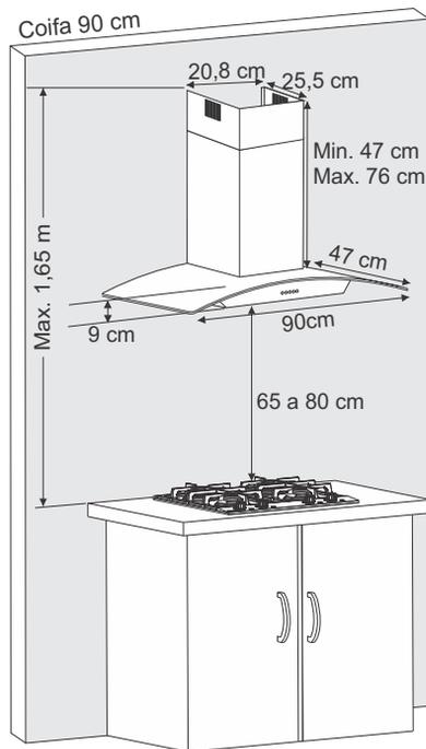
Preparar o local a ser instalado (modo exaustor, que necessita de saída de ar, ou depurador).
