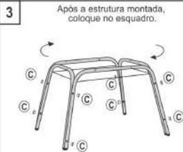
Após a estrutura montada, coloque no esquadro. Agora com a estrutura montada, coloque os tapa furo (C) sobre os orifícios visíveis.
