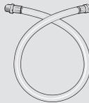
Use uma chave de boca de 22mm para fixar uma das extremidades do tubo flexível metálico na entrada de gás do fogão, não esquecendo de utilizar o anel de vedação que acompanha o aparelho no saco de acessórios (figuras 1 e 2).
