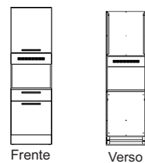
PAN FNO 2PT 1GV 60 Produto Montado C: 600 A: 2070 P:515 MM
