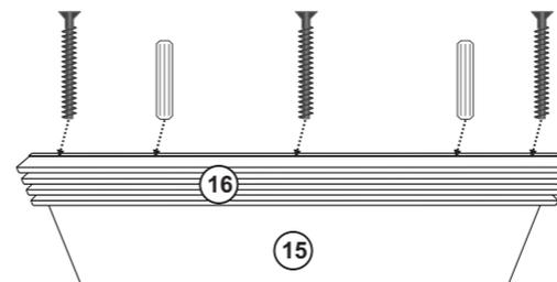
Fixar as peças 16 na peça 15 com Parafuso 5x50 e Cavilha.
