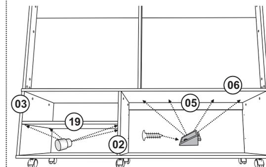
Fixar a peça 05 na peça 06 com Suporte angular e Parafuso 3,5x12 flangeado e com Cantoneira Metálica e Parafuso 3,5x12. Fixar os suportes da prateleira removível 19 nas peças 02 e 03.
