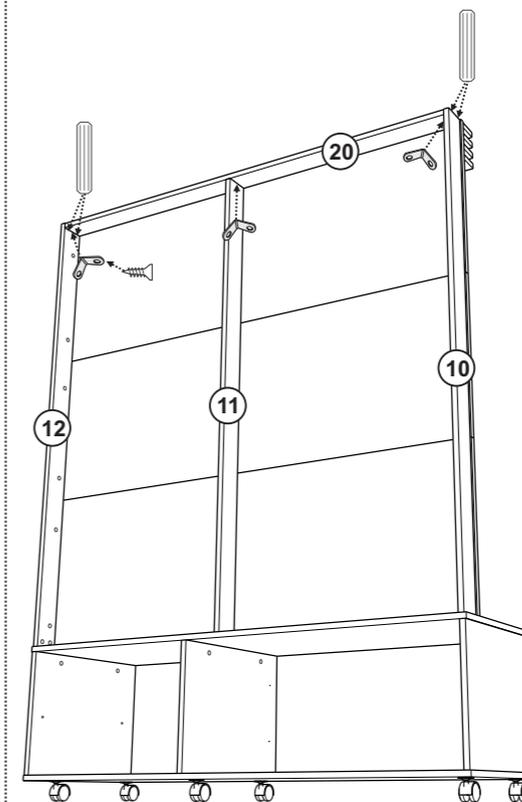
Fixar a peça 20 nas peças 10 e 12 com Cavilha e Cantoneira metálica e na peça 11 com Cantoneira metálica. Fixar as Cantoneiras metálicas com Parafuso 3,5x12.
