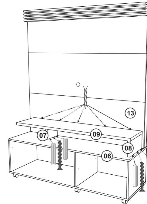
Fixar as peças 07 e 08 na peça 06 com Parafuso 5x50 e Cavilha. Fixar a peça 09 na peça 13 com Parafuso 5x35.
