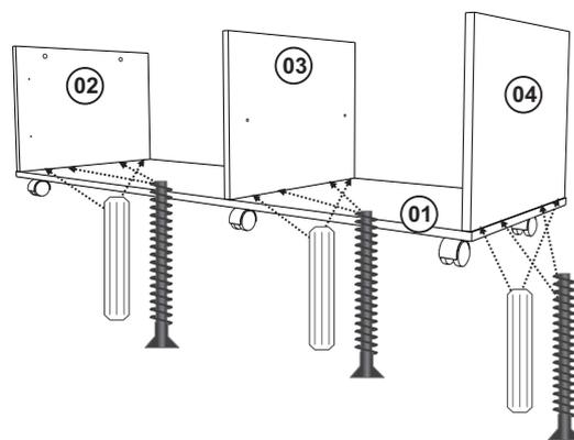
Fixar as peças 02, 03 e 04 na peça 01 com Parafuso 5x50 e Cavilha.
