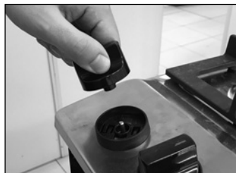
Botões removíveis com aro protetor (canopla)
