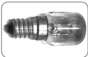
**Utilize somente lâmpadas de 25 W e com rosca E14, cujo uso seja recomendado para fogões. Assegure-se de que o aparelho está desligado antes de substituir a lâmpada, para evitar a possibilidade de choque elétrico. Para instalar/trocar a lâmpada do forno, siga as instruções da página 43.**
