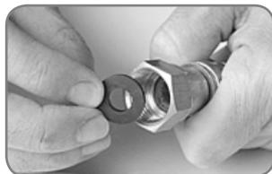
2. Coloque a arruela de vedação dentro da rosca interna da mangueira metálica.
