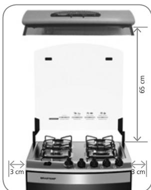
Para o local de instalação, deve-se prever uma distância mínima de 3 cm em toda a volta do fogão, para circulação de ar, e um vão mínimo de 65 cm entre a mesa e qualquer superfície acima dela (armários ou outros produtos, como coifas e depuradores).
