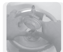
Enrosque o regulador na válvula do botijão
