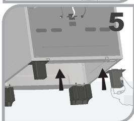
Após executar todos os passos acima, apoie o fogão diretamente em contato com o chão em uma área plana.
