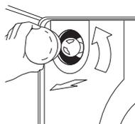
3. Puxe a lâmpada para removê-la do soquete. Substitua a lâmpada por outra similar de 220 V, 25 W. (Para aumentar a vida útil da lâmpada nova, evite manuseá-la com a mão nua, utilize luva ou pano) – Tipo halógenas G9.
