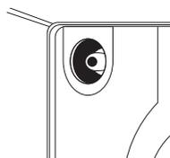
4. Volte a colocar a cobertura de vidro da lâmpada, rosqueando-a no sentido horário. A cobertura precisa ser colocada corretamente, pois ela protege a lâmpada das altas temperaturas do Forno.
