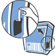
2. Segure o produto e puxe a fita na direção horizontal para retirar o calço de proteção do compressor.
