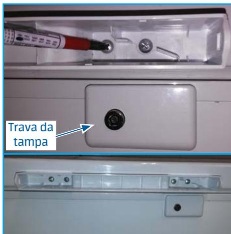
2. Pressione com as duas mãos em ambos os lados da tampa do puxador até que esta se encaixe completamente no puxador.
