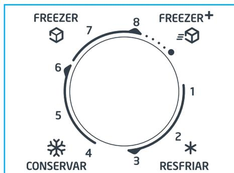
2. Para utilizar o aparelho como refrigerador, ponha o termostato entre as posições 1 e 3 (RESFRIAR).
