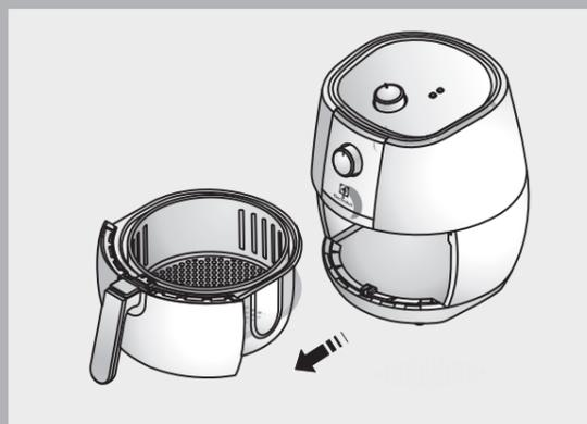
3. Depois retire o cesto removível, deslizando para trás a proteção do botão de liberação do cesto e pressione o botão que libera o cesto.
