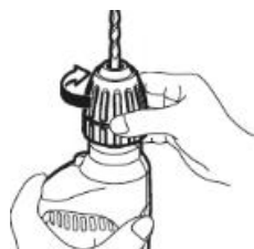
Fig. 4 – Demonstrativo para soltar o mandril de aperto rápido
