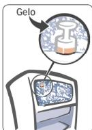
Proceda a operação de degelo sempre que a camada de gelo cobrir a faixa vermelha do pino indicador de degelo, localizado na parte superior do congelador. Se a espessura do gelo for maior que a altura do pino, o tempo de degelo aumenta, podendo
