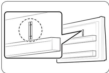
O refrigerador possui um indicador de limite de carga na parte de cima do lado direito do compartimento do freezer.
