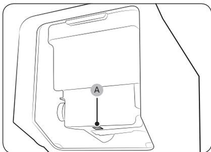
Se o mecanismo de fabricação de gelo automático não produzir gelo, remova o balde de gelo e pressione **Testar (A)** para verificar se o mecanismo de produção de gelo automático está funcionando corretamente.
