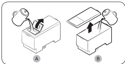
2. Abra a tampa frontal (A) da proteção ou a proteção inteira (B) e encha o tanque com um máximo de 5 L de água.
