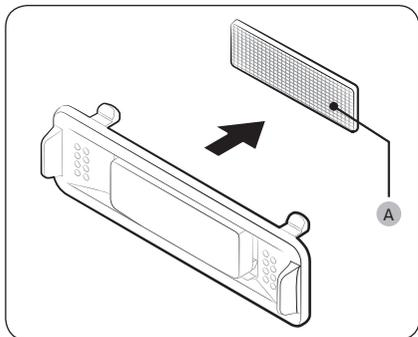
Enquanto segura os lados superior e inferior do compartimento do filtro, desbloqueie o compartimento do filtro para revelar o **filtro do desodorizador (A)**. Substitua o filtro e, em seguida, insira novamente o compartimento.
