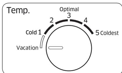
Para ativar o modo Férias, gire o disco da geladeira para selecionar **Vacation (Férias)** ou ☾ (nível de férias). A temperatura da geladeira será controlada a menos de 17 °C, mas o freezer permanecerá ativo, conforme definido anteriormente. O modo Férias será desativado automaticamente se ajustar a temperatura da geladeira.
