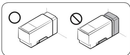
3. Insira novamente o depósito de água e encaixe-o no mecanismo do dispensador. Certifique-se de que o lado da frente (com a tampa da frente) do depósito esteja voltado para a frente.
