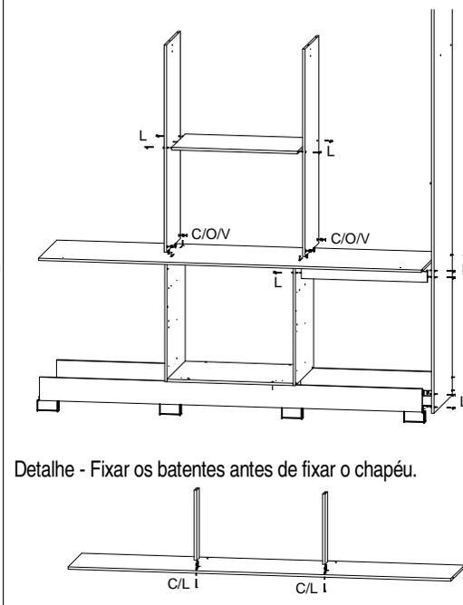
Passo 5 - Fixar lateral esquerda, travessa, chapéu com batentes e tampo
