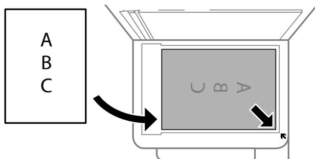
**Observação:** As bordas do seu original podem ser cortadas 1,5 mm da borda do vidro do scanner. Posicione manualmente o seu original afastado das bordas para prevenir corte.
