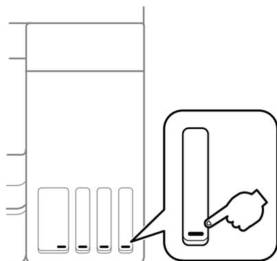
**Observação:** O produto tem um sistema de alerta de pouca tinta. A exatidão desse sistema depende dos tanques serem recarregados corretamente pelo usuário. O produto não pode medir diretamente os níveis da tinta nos tanques, então ele faz uma estimativa da quantidade de tinta restante através do monitoramento interno do uso da tinta. O sistema de alerta de pouca tinta pode gerar mensagens imprecisas se os tanques de tinta não forem recarregados de acordo com estas instruções.
