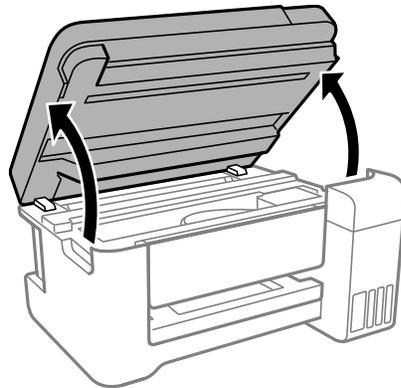
3. Abra a cobertura do tanque de tinta, depois abra a tampa do tanque de tinta que vai carregar.
