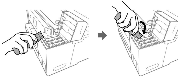
**Observação:** Veja a etiqueta de cor na unidade do tanque de tinta para identificar a cor de cada tinta. Não force as garrafas no lugar; elas são projetadas para cada cor.
