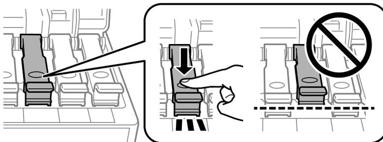
9. Feche a cobertura do tanque de tinta e a unidade do scanner.
