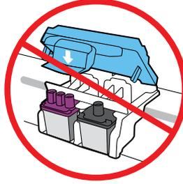
Após a instalação, não abra a trava azul a menos que seja para instalar novos cabeçotes de impressão ou para movimentar a impressora para fora de casa ou do escritório.
