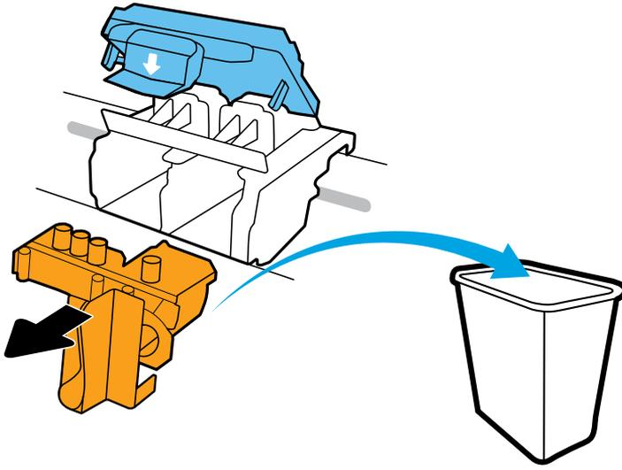
Remove e descarte a peça laranja de plástico. Manipule com cuidado para evitar manchas de tinta.
