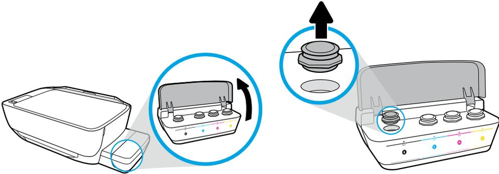
Abra a tampa do tanque de tinta. Remova o tampão do tanque preto.
