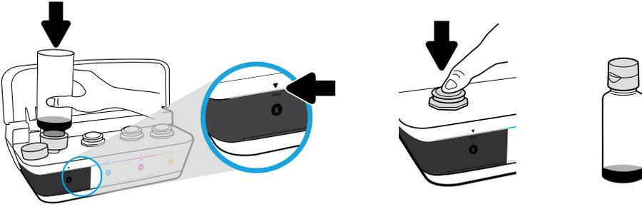
Segure a garrafa sobre o bocal do tanque. Encha de tinta até a linha. Recoloque o tampão e pressione-o com firmeza para fechar.
