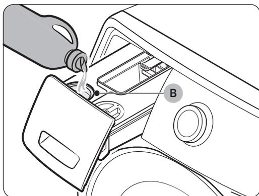
3. Se necessário, coloque a quantidade adequada de amaciante no compartimento Auto Amaciante (B).
