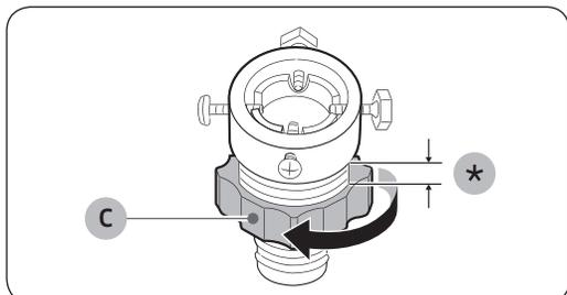
3. Segure o adaptador e gire a **peça (C)** na direção da seta, afrouxando-o 5 mm (\*).
