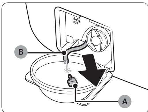
3. Coloque um recipiente grande e vazio ao redor da tampa e estique o tubo de drenagem de emergência até ao recipiente enquanto segura a **tampa do tubo (A)**.
