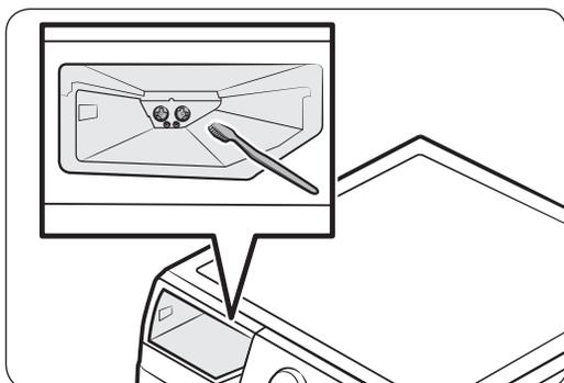
7. Limpe a reentrância da gaveta com uma escova macia. Certifique-se de que limpa as tampas das válvulas para evitar entupimento.
