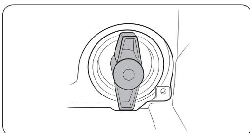
4. Limpe o filtro da bomba usando uma escova macia. Verifique se a hélice de bombeamento de drenagem dentro do filtro não está bloqueada.
