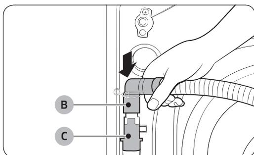
2. Pressionando os ganchos da abraçadeira, conecte a mangueira de drenagem (B) à mangueira de extensão (C). Em seguida, libere os ganchos para prender a mangueira de drenagem (B).
