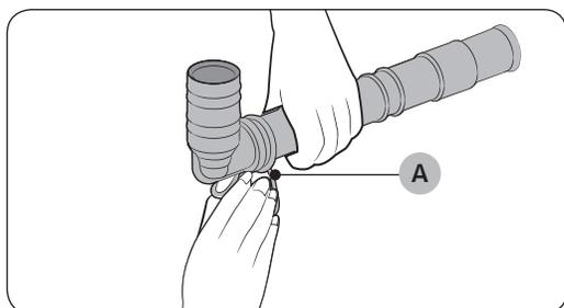
1. Pressione os ganchos da abraçadeira (A) e coloque a abraçadeira ao redor da mangueira de drenagem.
