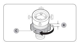
**3.** Segure o adaptador e gire a **peça (C)** na direção da seta, afrouxando-o 5 mm (\*).
