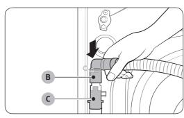
2. Pressionando os ganchos da abraçadeira, conecte a mangueira de drenagem (B) à mangueira de extensão (C). Em seguida, libere os ganchos para prender a mangueira de drenagem (B).
