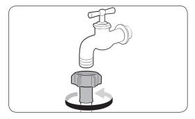
7. Se utilizar uma torneira de água do tipo rosca, utilize o adaptador tipo rosca para conectar a mangueira de água à torneira, conforme mostrado.
