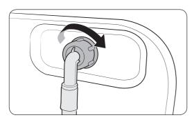
**8.** Conecte a outra ponta da mangueira de água à válvula de água de fornecimento na parte traseira da lavadora de roupas. Para apertar, gire a mangueira no sentido horário.
