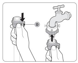
**6.** Pressionando a **peça (D)** para baixo, conecte a mangueira de água ao adaptador. Em seguida, solte a **peça (D)**. Um som de "clique" indica que a mangueira se encaixou ao adaptador.
