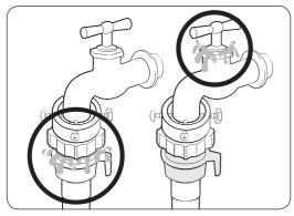
Abra a torneira e verifique se não há vazamentos em torno das áreas de conexão.
