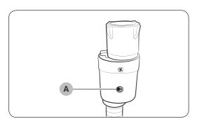
A mangueira aqua stop alerta os usuários sobre o risco de vazamentos de água. Ela detecta o fluxo de água e fica vermelha no indicador (A) em caso de vazamento.
