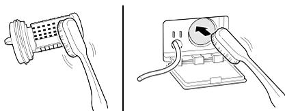
**6** Depois de limpar o filtro da bomba de drenagem, reinsira cuidadosamente o filtro e aperte a tampa de drenagem de volta no sentido horário com cuidado para evitar roscas cruzadas e vazamentos.
