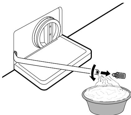
**4** Desaparafuse o filtro da bomba de drenagem lentamente para drenar a água restante e
