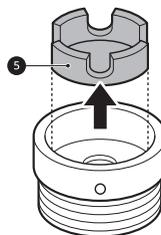
3 Empurre o adaptador na extremidade da torneira para que o vedante de borracha seja conectado à água. Aperte os 4 parafusos de fixação e a placa do anel adaptador.
