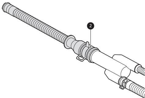
4 Conecte com segurança a mangueira de drenagem curta a uma valeta de drenagem ou cano vertical.
