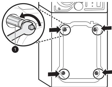
**2** Remover os parafusos de montagem, balançando-os ligeiramente enquanto os puxa para fora.
