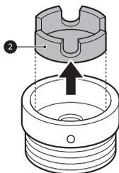
3 Empurre o adaptador na extremidade da torneira para que o vedante de borracha seja conectado à água. Aperte os 4 parafusos de fixação.
