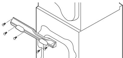
**3** Empurre para abrir as tampas dos lados esquerdo e direito do painel de controle na parte da frente do aparelho. Solte os parafusos sob as tampas.
