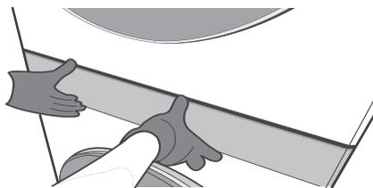
**5** Desconecte o chicote elétrico da máquina de lavar **1** e secadora **2** do painel de controle.
