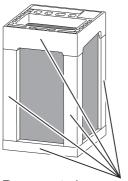
Remover todos os calços da embalagem antes de iniciar a utilização da lavadora. Nunca utilize a lavadora sobre o calço de EPS que acompanha o produto. Ele não suporta o peso da água e danifica os componentes inferiores da lavadora.
