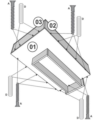
Fixar a peça 01 nas peças 02, 03, 04 e 05 com Parafuso 5x40 e Cavilha.
