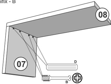
Fixar a peça 07 na peça 08 com Cavilha e Minifix.
