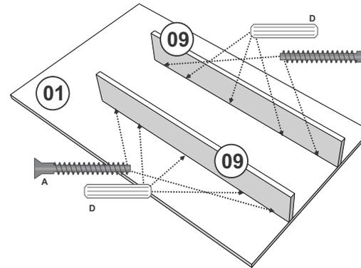
Fixar as peças 09 na peça 01 com Parafuso 5x40 e Cavilha
