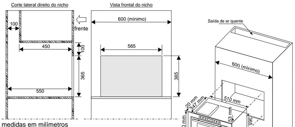
Caso o forno micro-ondas seja instalado no mesmo móvel que o forno elétrico de embutir Fischer, deve-se seguir as instruções específicas de instalação para nicho forno elétrico e forno micro-ondas Fischer, conforme desenhos abaixo.
