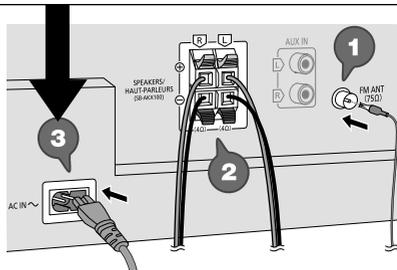
Para a tomada de conexão da rede elétrica CA
