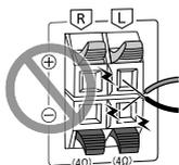
Tenha cuidado para não cruzar (curto-circuitar) ou inverter a polaridade dos cabos das caixas acústicas; isso pode danificar as caixas acústicas.
