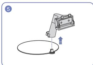
Remova a haste do suporte do suporte na direção mostrada na figura.
