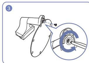
Remova o suporte da base, girando o parafuso na direção da seta conforme mostrado na figura.
