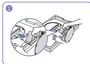
Pressione a parte inferior do monitor com uma das mãos e puxe a base com a outra na direção da seta, conforme mostrado na figura.
