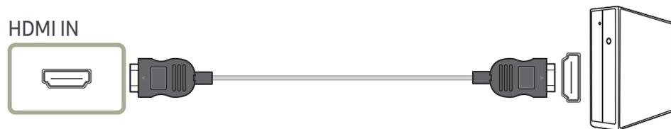
— Quando conectar um cabo HDMI, utilize o cabo que acompanha os componentes do produto. Se você utilizar um cabo HDMI diferente do que foi fornecido pela Samsung, a qualidade da imagem poderá ser degradada.
