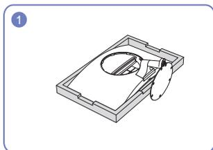
Coloque no chão a almofada protetora Styrofoam incluída no pacote e posicione o produto com a face voltada para a almofada, conforme mostrado na imagem. Se uma Styrofoam (espuma de poliestireno) não estiver disponível, utilize um tapete espesso.
